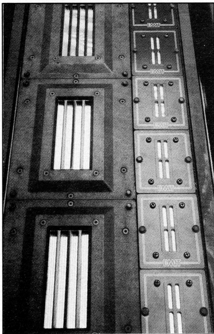
I trasduttori isodinamici EMIM ed EMIT sono strutturalmente molto simili, ma dimensionati per gamme diverse.
